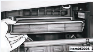
محل نصب فیلتر هوا
