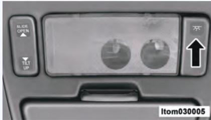
کلید چراغ‌های داخل اتاق
